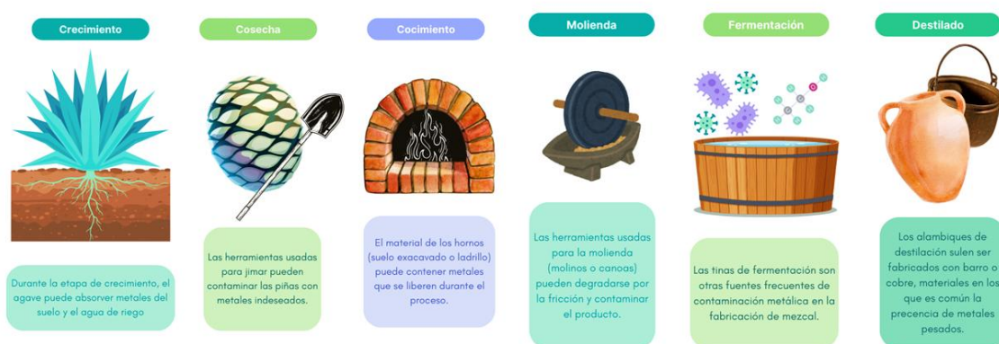
Ilustración 3: Principales fuentes potenciales de contaminación de metales pesados durante el proceso de producción de mezcal
